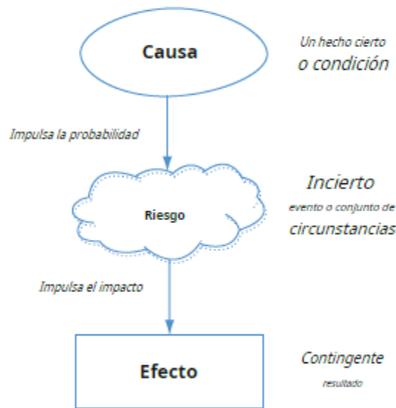
Figura 2.1 Modelo simple de causa-riesgo-efecto
